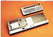
Tasti e tastiera di sistema Sharp PC-1500 e CE-150 presso del collegamento interfaccia - stampante
